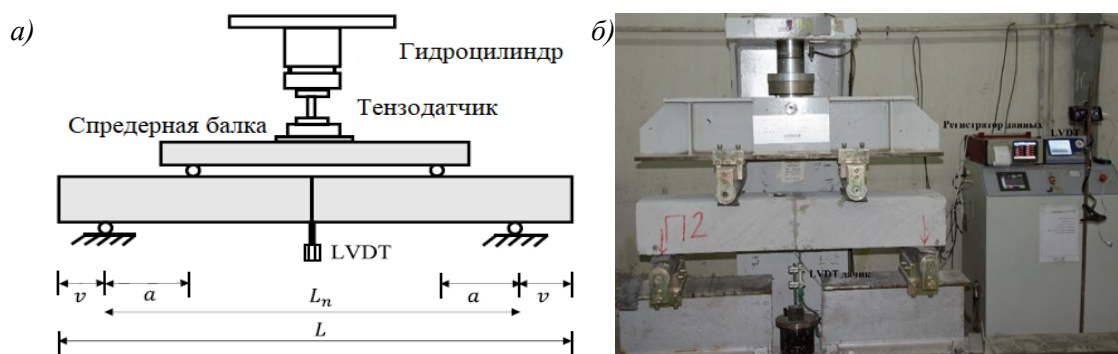
Рис. 2. Система загрузки: а – схема испытаний перемычек; б – установка для испытаний: L – длина балки; L_n – длина пролета в свету; a – пролет сдвига
