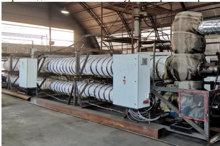
Рис. 7. Опытно-промышленная установка низкотемпературного термолиза, расположенная на ООО «ТК «Экотранс». Производительность Q – 500 кг/ч
