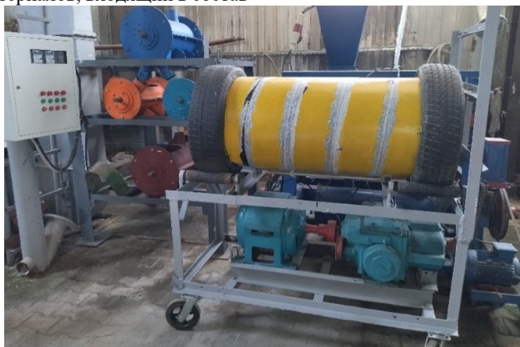
Рис. 8. Барабанно-винтовой агрегат для агломерирования полидисперсных материалов. Производительность Q – 200–300 кг/ч
