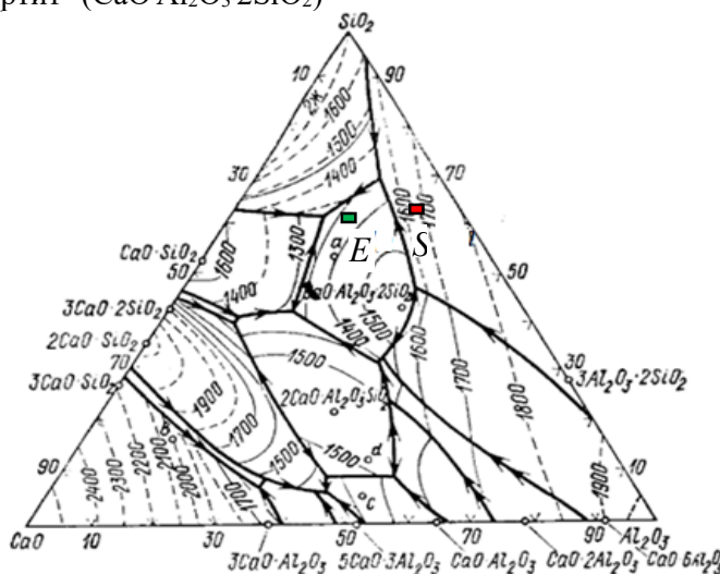
Рис. 3. Расположение экспериментальных составов стекол Е и S на диаграмме состояния \text{CaO}-\text{Al}_2\text{O}_3-\text{SiO}_2
